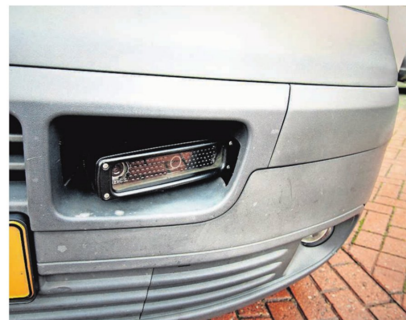
▲ Scanner in de voorbumper van de scanbus.
